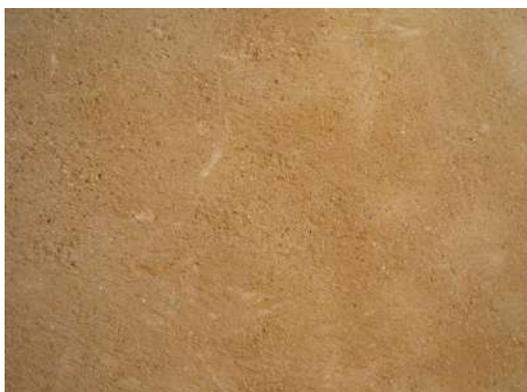
exemple d'enduit de finition à la chaux
