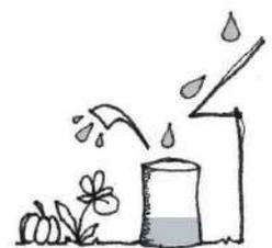
Le processus de rétention-infiltration se caractérise par la création dans le sol d'un espace de rétention perméable à l'eau pluviale, tel qu'un jardin de pluie, une noue, etc. Cet aménagement permet à l'eau d'être retenue partiellement et ponctuellement avant son infiltration dans le sol puis dans la nappe phréatique.
